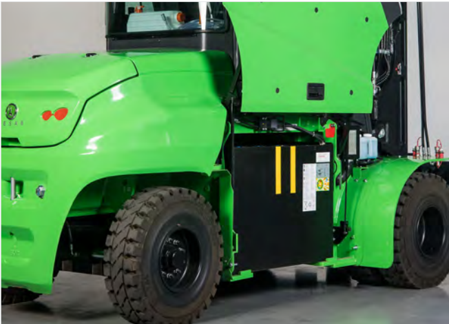
Offenes Gehäusedesign mit Seitenwand erleichtert die seitliche Batteriewechsel .
