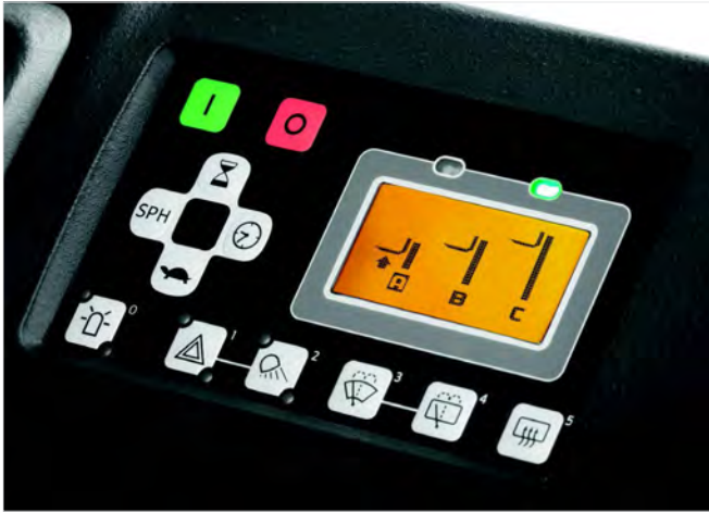
Die Voreinstellung der Hubhöhe spart dem Fahrer Zeit und Mühe.
