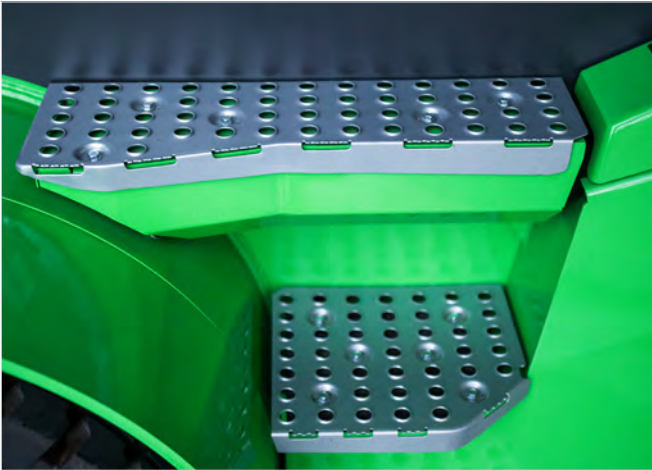
Ein großes Einstiegsfenster mit breiten Trittstufen und doppelten Haltegriffen sorgt dafür, dass die Ermüdung des Fahrers bei Einsätzen, die ein wiederholtes Ein- und Aussteigen erfordern, minimiert wird.
