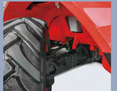
Die pendelnde Lenkachse hält das Fahrzeug auch beim Überfahren von Hindernissen im Gleichgewicht.
