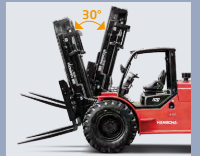
Neigebereich des Masts nach vorne und hinten jeweils 15°. Ideal für Ladevorgänge und Transport in unwegsamem Gelände.
