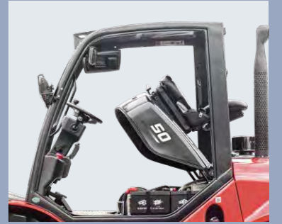
Maschine durch leicht zu öffnende Klappe zugänglich.
