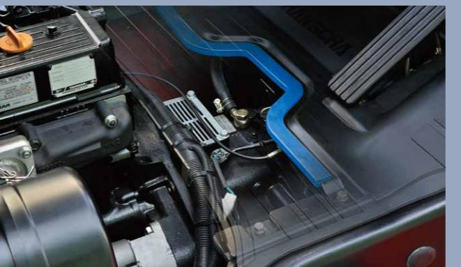
1. Zusätzlich zu den Gummidämpfern zwischen dem Dach und den Rahmen sorgen ein Verbundmotordämpfer und ein schwimmend gelagerter Antriebsstrang für eine flexible Verbindung zwischen dem Rahmen und dem Antriebssystem, wodurch Fahrschwingungen und Vibrationen des Antriebssystems erheblich reduziert werden können.
