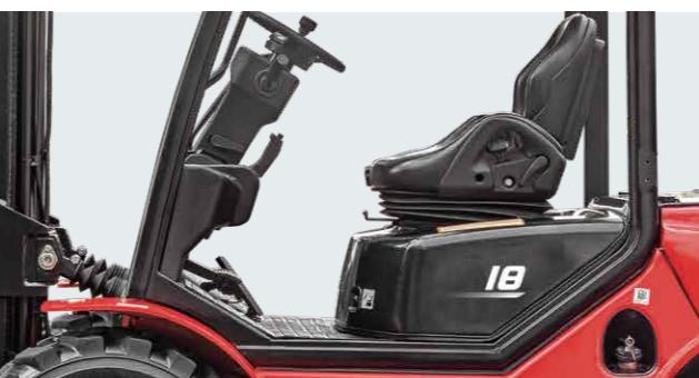
Der leicht zu öffnende Haube ermöglicht einen schnellen Zugang zum Motorraum.
