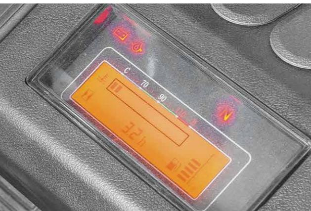
Das neu entwickelte LCD-Instrument verfügt über umfassendere Funktionen, eine stabilere Leistung und kann den vollständigen Status, den Fehlercode und andere wichtige Informationen des Staplers vollständig anzeigen, sodass der Bediener den Status intuitiver verstehen kann und erleichtert die Wartung.
