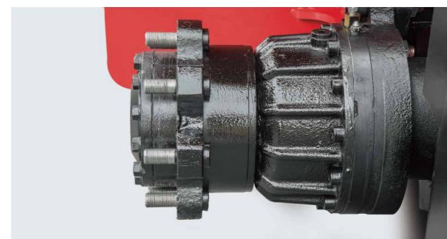
Die Nassbremse bietet maximale Lebensdauer für Ihr Bremssystem.
