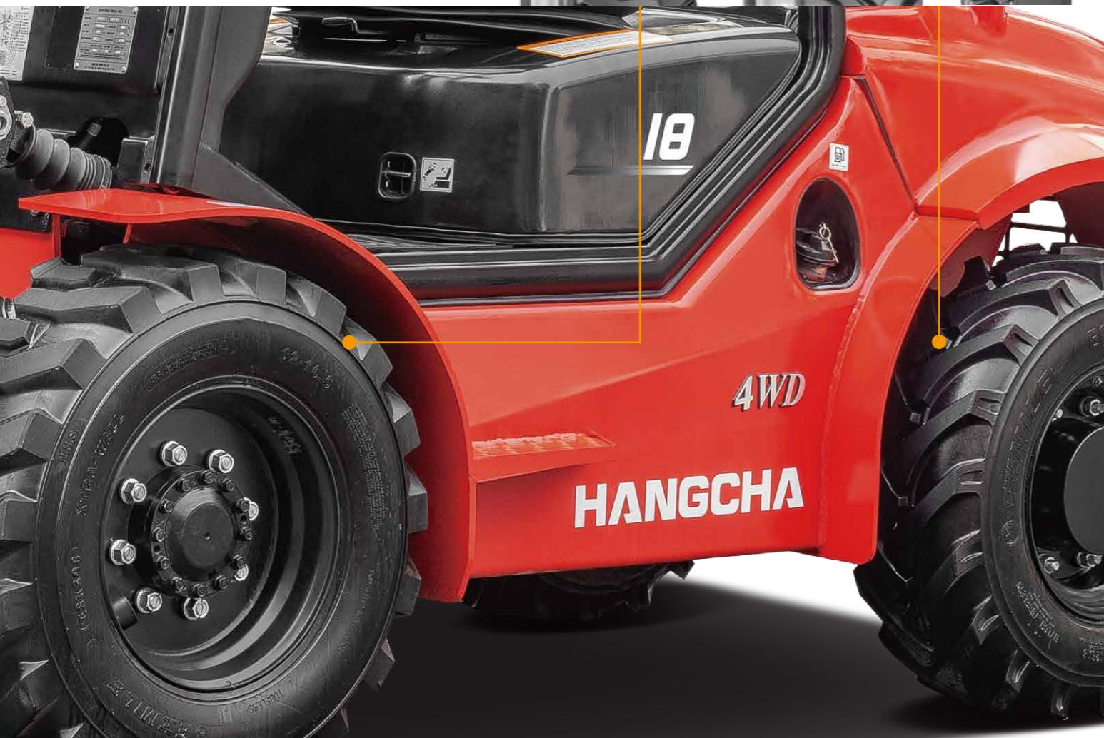
**Die oszillierende Lenkachse ermöglicht es jedem Rad Hindernisse zu überwinden und hält die ladestufe das LKW und Ladungsniveau.**
