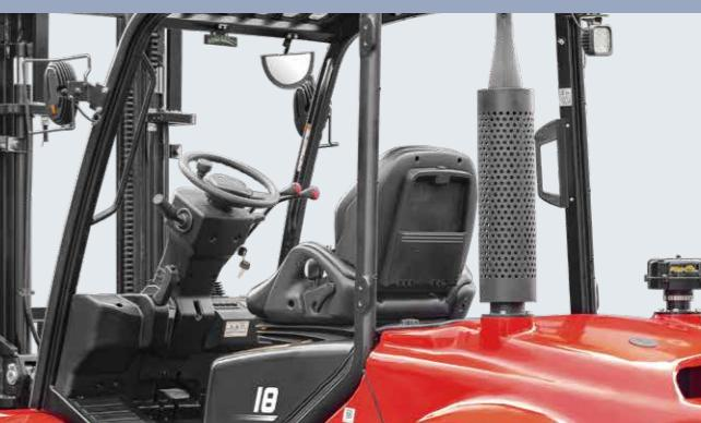
4. Aufgrund des größeren Abstandes zwischen den inneren Masten bietet der Gabelstapler eine breite Sicht nach vorne.
