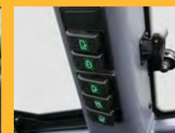
Zusammengefasste Schalterleiste, Steckdose mit Dauerstrom
