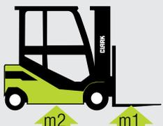
**Bodenfreiheit mit Last unter dem Hubgerüst (m1) und Mitte Radstand (m2):**
