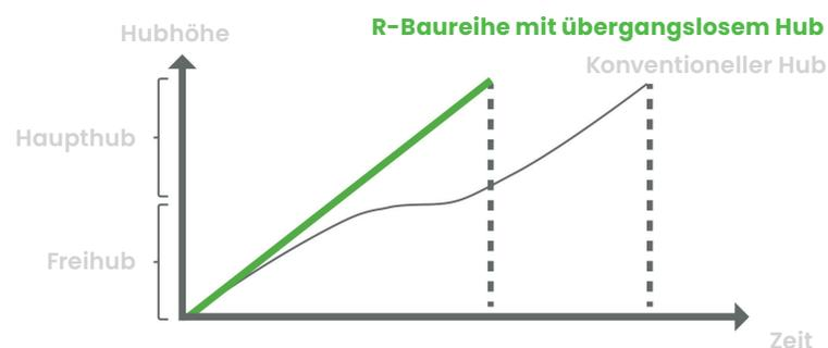
Eines der wichtigsten Kriterien dieses neuen Mastes ist die übergangslose Hubsteuerung. Beim Heben und Senken des Mastes bewegen sich der Freihub und Haupthub gleichzeitig, um einen reibungslosen und stoßfreien Hub zu ermöglichen. Dies ermöglicht außerdem ein wesentlich schnelleres Heben und Senken, da sich der Mast in einem linearen Hub bewegt.
