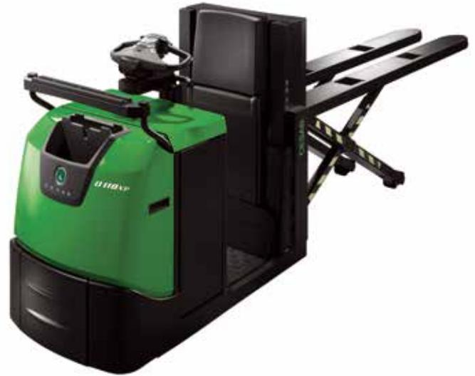
Die P-Version ermöglicht dem Bediener eine Fahrplattformhöhe von 1000 mm zu erreichen, um auf der zweiten Ebene zu kommissionieren (~ 2,7 m). Eine Vielzahl von Gabelabmessungen sind lieferbar.
