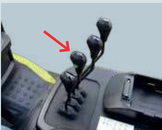
Aktivierungsschalter am mechanischen Hydraulikhebel
