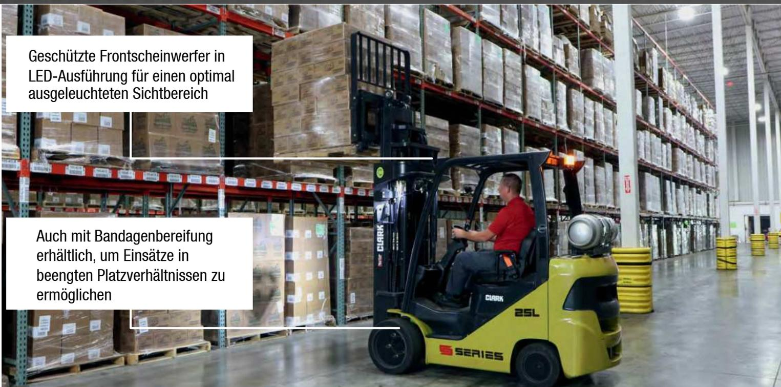
Geschützte Frontscheinwerfer in LED-Ausführung für einen optimal ausgeleuchteten Sichtbereich
