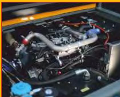
Die HX-Serie verfügt über einen leistungsstarken, hocheffizienten Dieselmotor aus dem Hause HATZ. Der 2,0l Stufe V – Motor hat eine Leistung von 55 kW und ist mit einem Dieselpartikelfilter (DPF) und einem Dieseloxidationskat (DOC) ausgerüstet. Die Zugabe von AdBlue ist nicht nötig.
