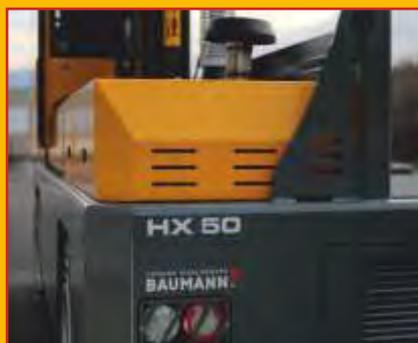
Um Beschädigungen des Motors und des Antriebssystems bei staubigen Einsätzen zu vermeiden, sind sämtliche Luftein- und -auslässe oberhalb der Plattform angebracht. Robuste Abdeckungen schützen vor Beschädigungen durch überstehendes Ladegut.
