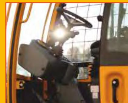
Die neuen Deluxe-Panoramakabinen der Baumann HX-Serie bieten rund 20% mehr Platz, als die in der Vergangenheit aufgebauten Varianten. Die vibrationsfrei, mittels großer Hydrolager vom Chassis abgekoppelten Kabinen machen zusammen mit hochwertigen Fahrersitzen den Baumann HX zu einem komfortablen und ergonomischen Arbeitsplatz.
