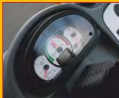
Unser einfaches, selbsterklärendes Display bietet dem Bediener alle wichtigen Informationen auf einen Blick. Das optional erhältliche Optifleet-System ermöglicht eine digitalisierte Zugangskontrolle, die Dokumentation des vorgeschriebenen Pre-Op-Checks sowie die Überwachung, der für einen störungsfreien Betrieb relevanten Parameter.
