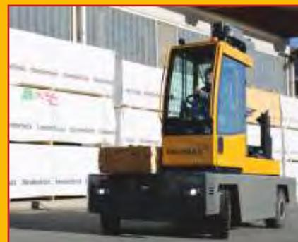
Die hydraulisch kontrollierten Pendelachsen gleichen permanent Unebenheiten auf den Fahrwegen aus. Plattform und Last bleiben sicher und stabil in der Waagerechten.
