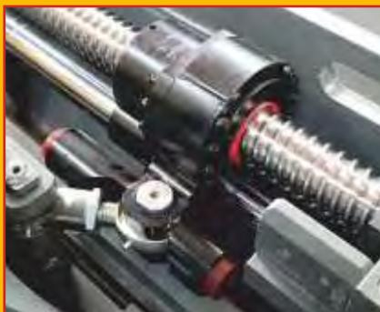
Das Variable Reach System (VRS), ein preisgekröntes und patentiertes Ausfahrwerk für den Hubmast, bietet Präzision, Geschwindigkeit und reduzierte Wartungskosten. Der Mastauschub, der in der aktuellen Generation über zwei Archimedes-Spindeln und zwei zusätzliche Linearführungen geführt wird, ermöglicht das präzise Positionieren der Last auch in großer Arbeitshöhe. Diese fortschrittliche Technologie trägt dazu bei, die Sicherheit beim Umgang mit langen Ladegütern zu erhöhen.
