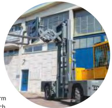
≡ **Z**u den meistverkauften Anbaugeräten gehören die hydraulische Zinkenverstellung, die höhenverstellbare Niveaugabel und Ausschubscheren bzw. Teleskopgabeln.
