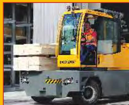
Der EGX verfügt über zwei Antriebsmotoren und eine 120 V Batterie mit großer Kapazität und langer Laufzeit. Die Ausstattung mit einer geräumigen Panoramakabine, LED-Beleuchtung, einer leistungsfähigen LoadSensing-Hydraulik und dem VRS-System machen den Baumann EGX zu einer echten Alternative zum verbrennungsmotorischen Seitenstapler.
